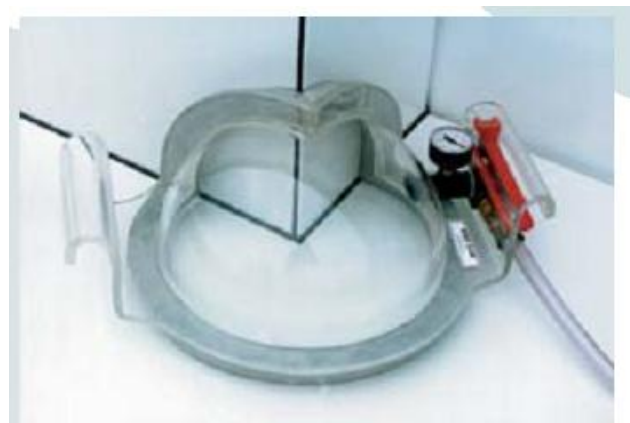
Vakuumprüfglocke für Außenecken
