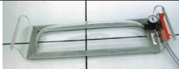
Vakuumprüfglocke für gerade Nähte
